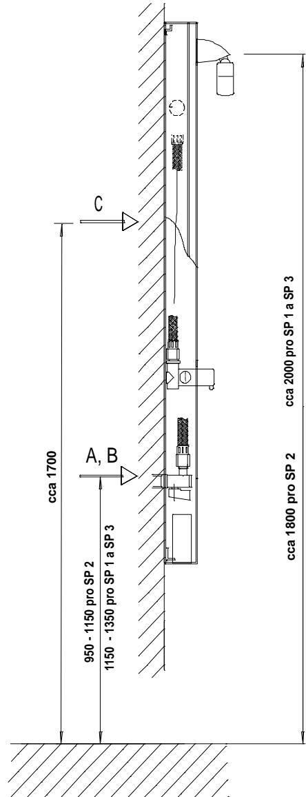
Teplota vody se nastavuje pomocí termostatického ventilu, jehož rozsah je omezen dorazy na cca 25°C – 45°C.
