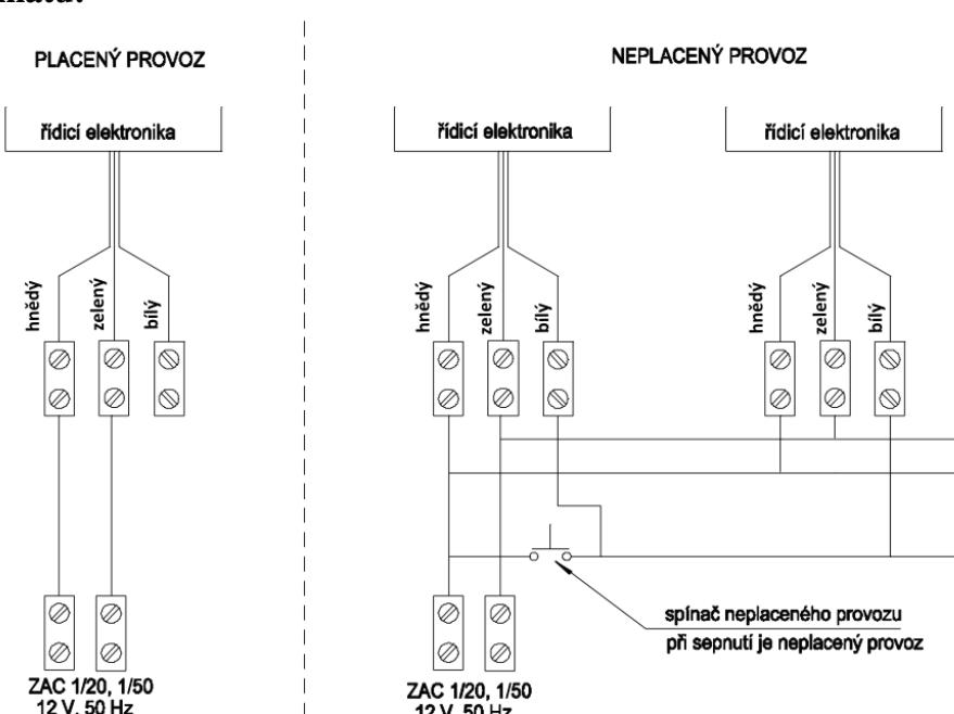
4. Připojit přívodní kabel 12 V 50 Hz na připojovací svorkovnici. Pro placený provoz musí být napájecí napětí přivedeno na hnědý a zelený vodič – bílý vodič zůstane nezapojen. Pro neplacený provoz musí být navíc propojený hnědý a bílý vodič.
