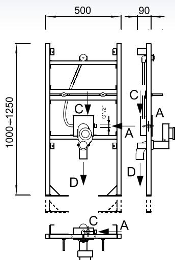
**KP 1** slouží k zavěšení libovolného pisoáru na nosné svorníky. Svojí konstrukcí zajistí rozložení zatížení do podlahy a zdí a tím umožňuje aplikaci závěsného provedení i u zdí s nižší nosností.
