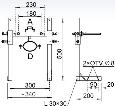
**KZ 1** slouží k zavěšení klozetu na nosné svorníky. Svojí konstrukcí zajistí rozložení zatížení do podlahy a zdí a tím umožňuje aplikaci závěsného provedení i u zdí s nižší nosností.
