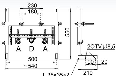
**KB 1** slouží k zavěšení bidetové mísy na nosné svorníky. Svojí konstrukcí zajistí rozložení zatížení do podlahy a zdí a tím umožňuje aplikaci závěsného provedení i u zdí s nižší nosností.
