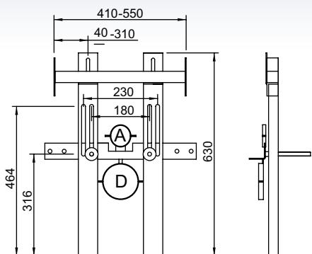
**KZS 1** slouží k zavěšení klozetu na sádrokartonovou stěnu. Svojí konstrukcí zajistí rozložení zatížení jak do podlahy, tak do nosných ocelových profilů sádrokartonové stěny. Vzdálenost těchto profilů může být 410-550 mm.
