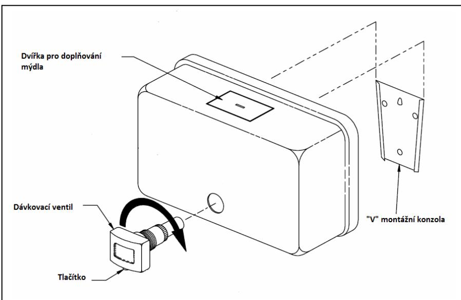
**DŮLEŽITÉ:** Hodnota pH použitého mýdla by měla být v rozmezí 6,5 až 8,5. Kyselejší mýdla (pH nižší než 6,5) způsobují korozi kovových dílů (i nerezových) a poškozují pryžové a plastové díly dávkovače. Zásaditější mýdla (s pH vyšším než 8,5) mohou způsobit vzdouvání materiálu, rychlé opotřebení pryžových částí dávkovače a podráždění pokožky.
